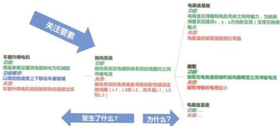
图 2.4-5 失效分析结构树示例
