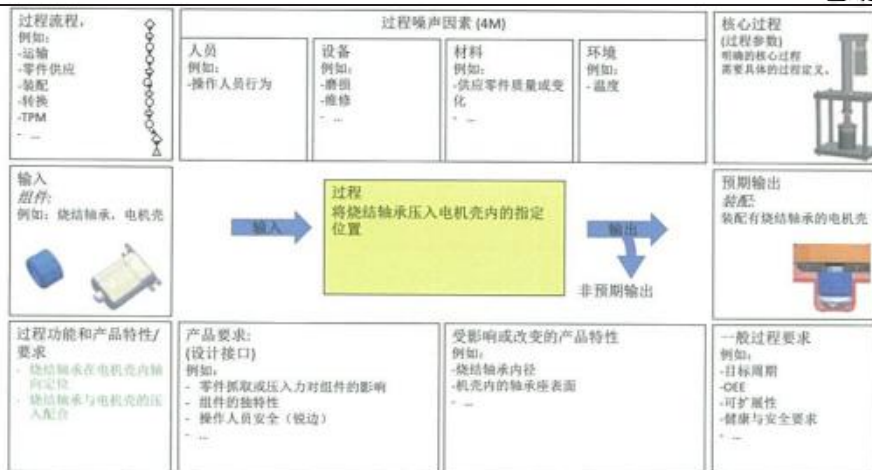
图 3.3-1 压入烧结轴承参数图示例
